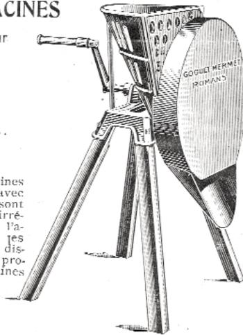
Nos coupe-racines à disque fermé avec protecteur tôle sont d'une construction irréprochable et ont l'avantage sur tous les coupe-racines à disques, d'éviter la projection des racines coupées tombant naturellement en dessous.
