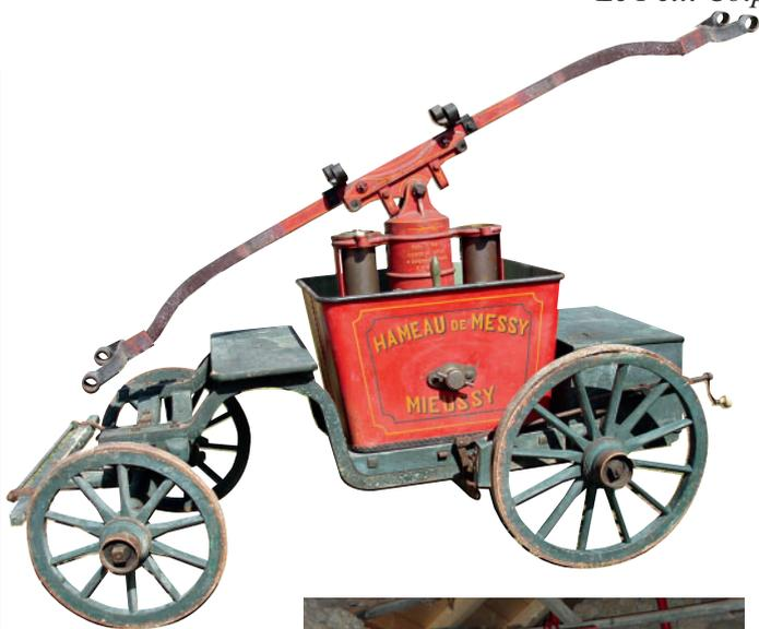
Pompe aspirante et refoulante. Reconnaisable grâce à la bouche d'arrivée d'eau sur la façade de la cuve. Visible également la cloche de pression encadrée des 2 cylindres.
