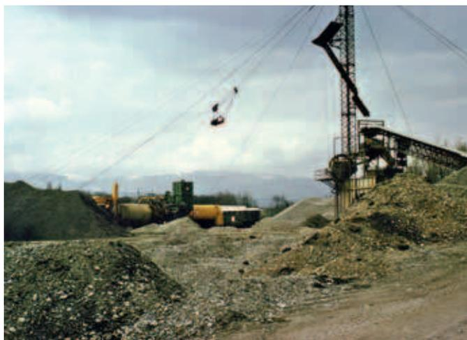
La drague-line montée avec le godet fixé sur un des câbles
